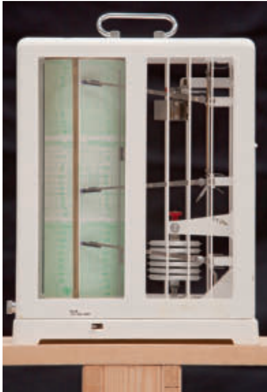
Aufzeichnung von Klimadaten mit einem Thermo-Hygrographen
