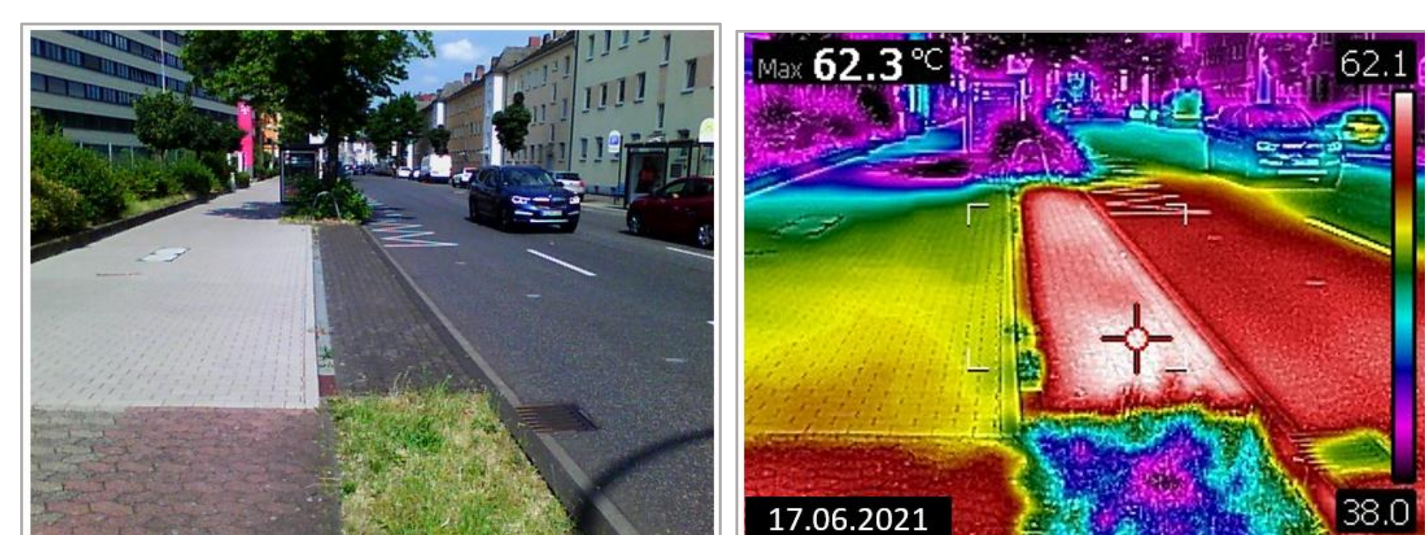
Abbildung 4: Wärmebildaufnahmen der Moselweißer Straße am 17.06.2021 (heißer sonniger Tag; T_L = 36,2^\circ\text{C} )
