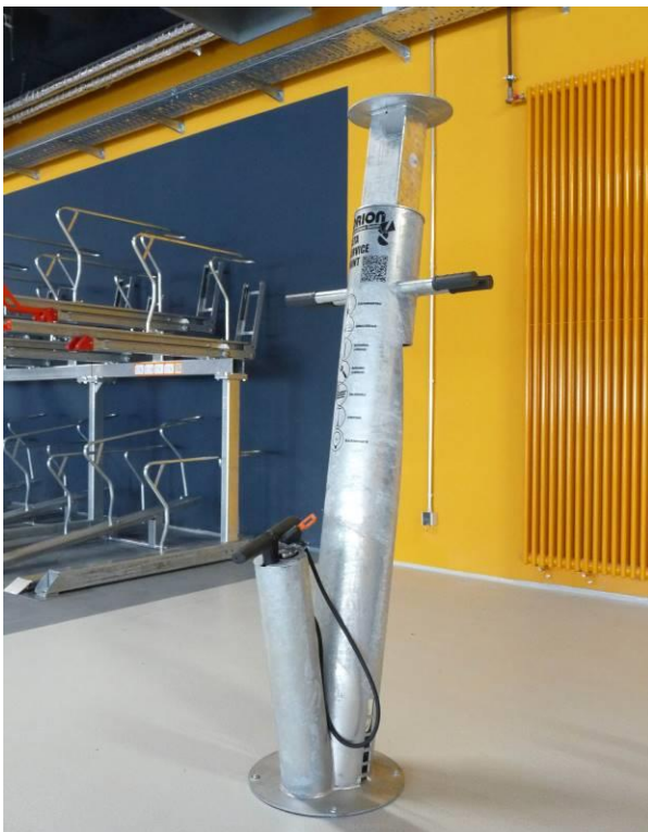
Service-Säule im Fahrradparkhaus
